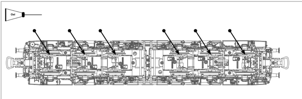
Si utilisation fréquente, huilez régulièrement avec une goutte d'huile fine pour machine à coudre. Nous vous conseillons un rodage complet de 25 min dans chaque sens pour un roulement optimal. Il est conseillé de nettoyer régulièrement vos rails pour un bon fonctionnement.
